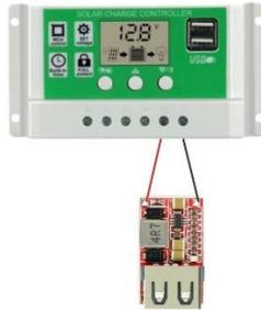
Gambar 8. Rangkaian Solar Charger Controller dengan StepDown USB 5 Volt
