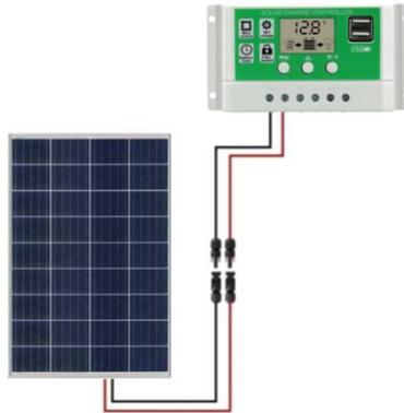
Gambar 4. Rangkaian Solar Charger Controller dengan Panel Surya
