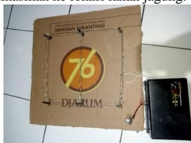
**Gambar 9.** Pengemasan Alat Pengusir Hama Tikus dengan Mikrokontroler
