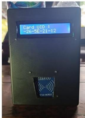
**Gambar 1.** Alat Identifikasi pasien lansia menggunakan RFID Card
