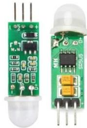
**Gambar 1. Bentuk fisik modul Sensor mini Pir**
