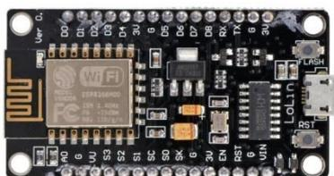
**Gambar 2. Bentuk fisik modul NodeMCU**
