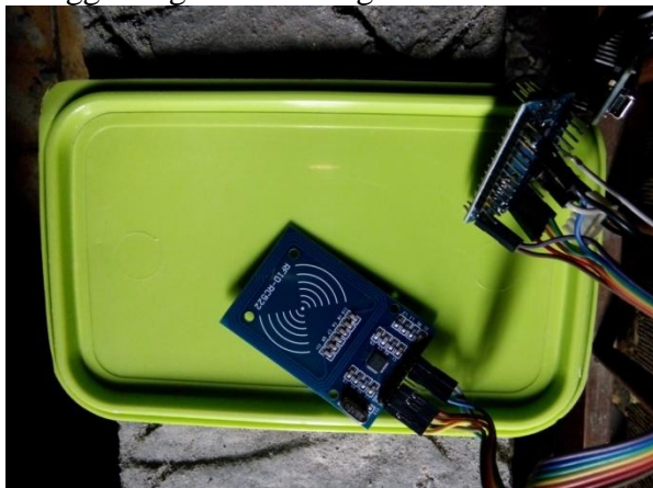
Gambar 11. Pemasangan RFID ke Arduino nano
