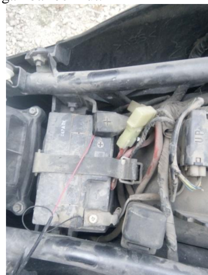
Gambar 20. Power suplay mengambil daya dari aki motor
