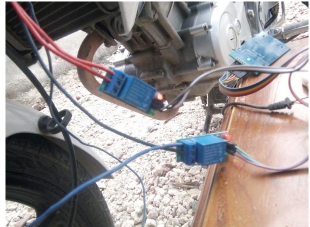
Gambar 19. Pemasangan Relay Pada Soket Kontak Dan Stater Pada Sepeda Motor
