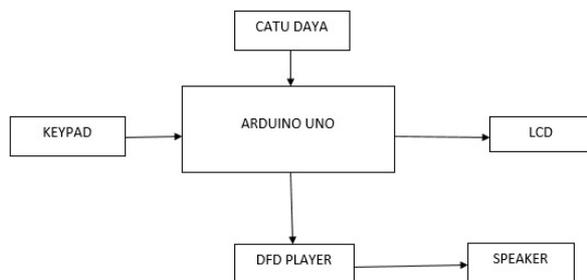
Gambar 1. Blok kalkulator untuk tunanetra
