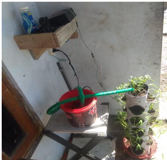
Gambar 4. Pengemasan Alat Sistem Penyiraman otomatis Vertikultur Tegak dengan Mikrokontroler
