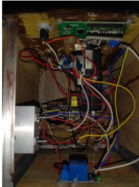
Gambar 1 Perancangan Alat Wifi Koin Setelah Dimasukan dalam Box
