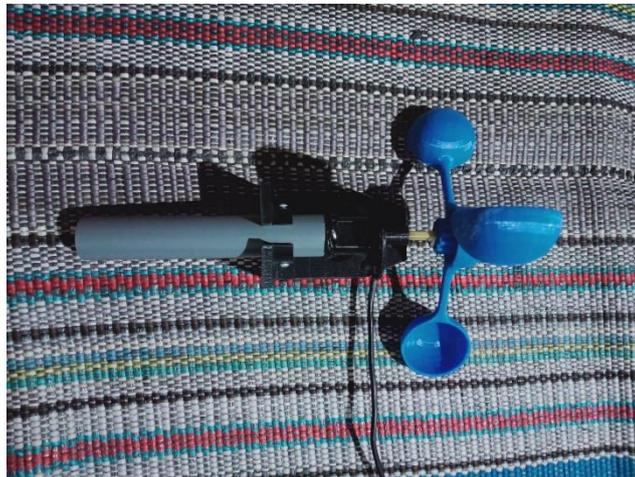
Gambar 2 Tampilan Sensor Kecepatan Angin
